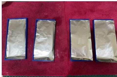
Gambar 3.17 Menutup Sampel dengan Aluminium Foil (Sumber: Dokumentasi Pribadi)
