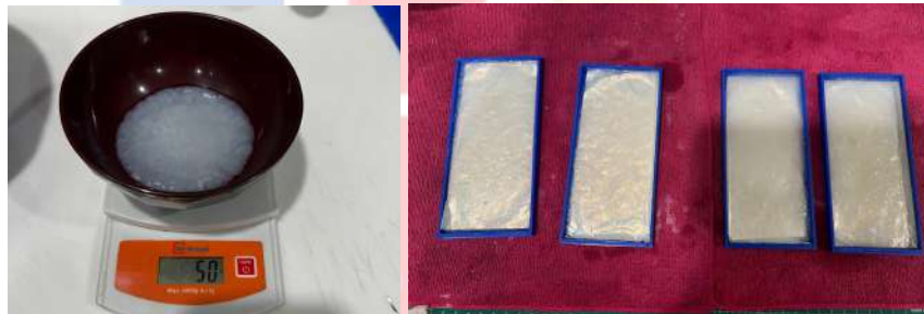
Gambar 3.16 Menimbang Sampel dan Dituangkan ke Cetakan (Sumber: Dokumentasi Pribadi)
