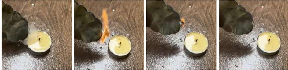
Gambar 4.2 Proses Pengujian Api Sampel AS5.2
