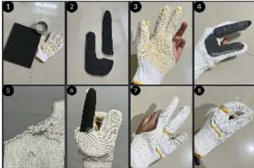
**Gambar 4.14. 1 Proses Pembuatan *Prototype* Sarung Tangan Pelindung Jari dalam Teknik Wudulan**
