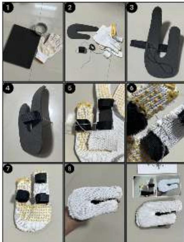
**Gambar 4.14. 2 Proses Pembuatan Prototype Pelindung Jari Kedua**
