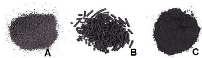
Gambar 5.25 Activated Charcoal a.)Granular b.) Butiran c.) Serbuk (Abbas, et.al., 2007)
