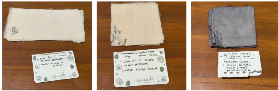
Gambar 4.14: Hasil Ekstraksi Panas Kulit Rambutan dan Pelarut Aseton (Kain Polos, Tawas, Tunjung (kiri ke kanan))
