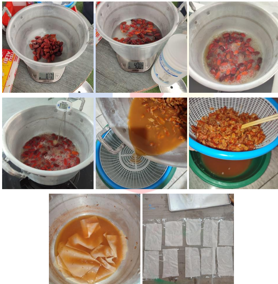
Gambar 4.1: Proses Ekstraksi Panas Kulit Melinjo
