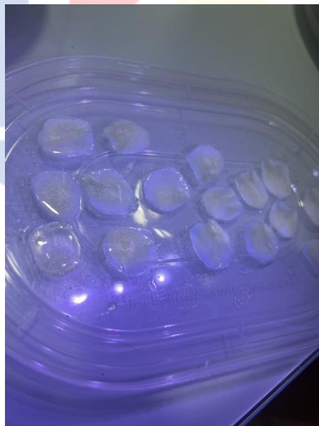
Gambar 4.27. Pengeringan sisik campuran resin menggunakan sinar UV
