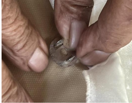
Gambar 4.34. proses memasukan magnet (Sumber: dokumen pribadi)
