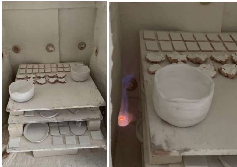
Gambar 4.60 Loading In Pembakaran Kedua dan Pembakaran Kedua sumber : Dokumentasi Pribadi (2025)
