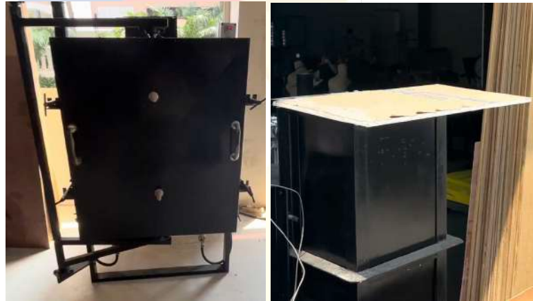
Gambar 4.56 Proses Pembakaran Pertama dan Cerobong Ditutup ( Kiln Shelf )
