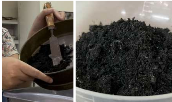
Gambar 4.18 Proses Pengayakan dan Tekstur Abu Setelah Diayak sumber: Dokumentasi Pribadi (2025)
