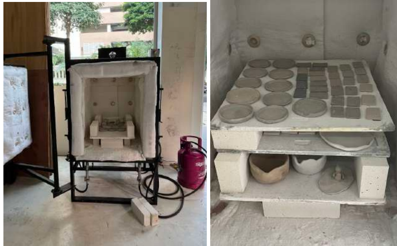
Gambar 4.55 Tungku Gas Keramik dan Loading In Pembakaran Pertama
