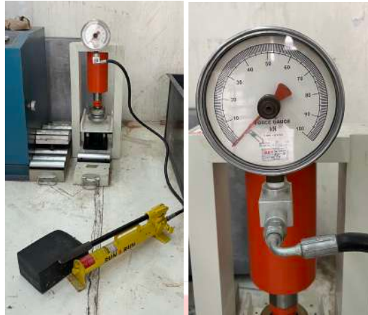
Gambar 4.75 Hydraulic Testing Machine sumber : Dokumentasi Pribadi (2025)
