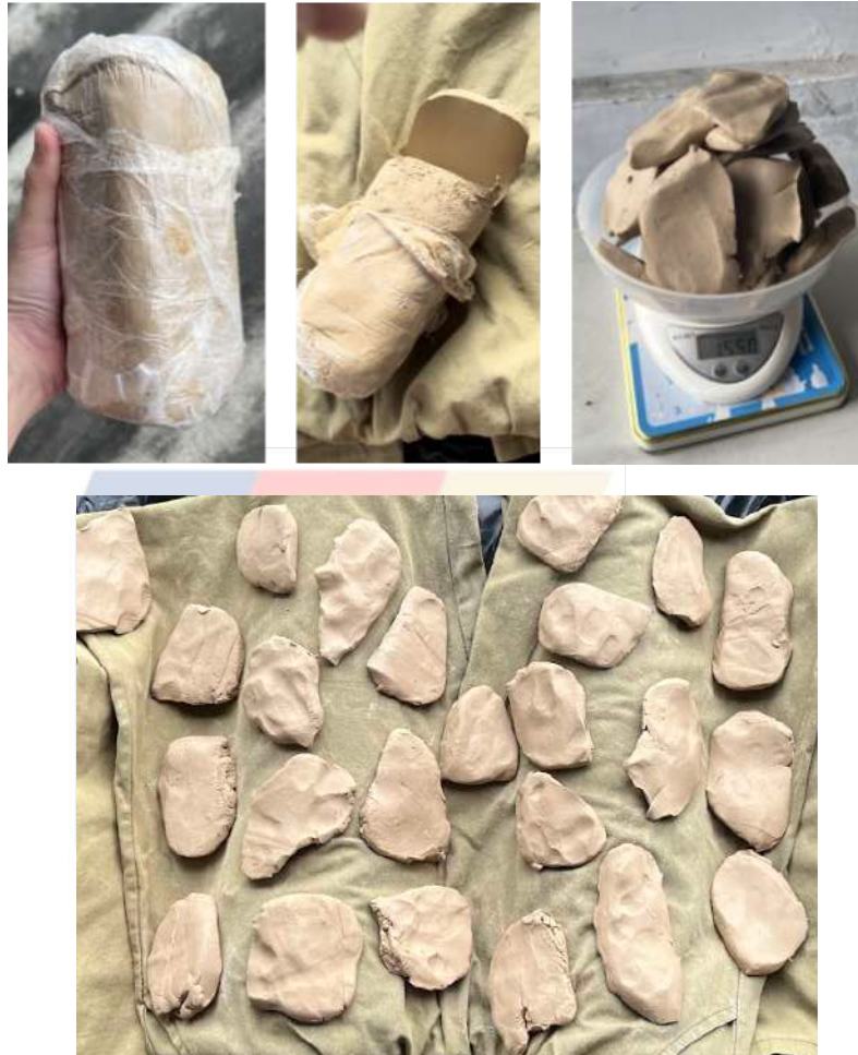
Gambar 4.7 Tanah Liat Lontong, Lempengan, Timbang Berat Basah dan Pengeringan sumber : Dokumentasi Pribadi (2025)
