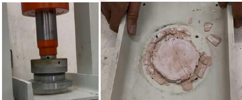
Gambar 4.77 Proses Uji Coba Tekan ( Sample Produk ) sumber : Dokumentasi Pribadi (2025)
