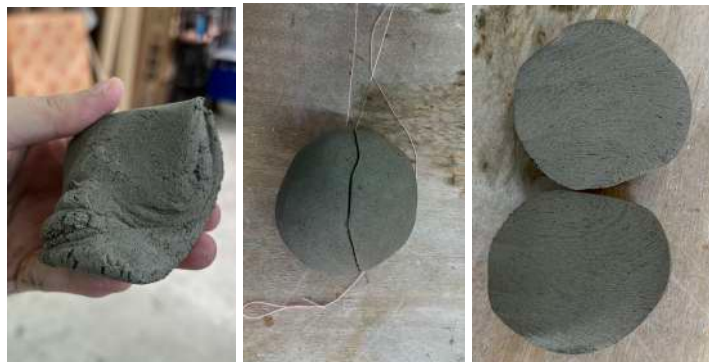
Gambar 4.31 Wedging , Tes Air Bubble dan Hasil Tes Air Bubble
