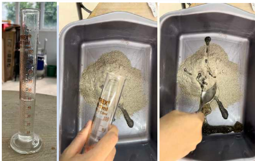
Gambar 4.30 Takaran Air 50 ml, Proses Pencampuran dan Pengadukan
