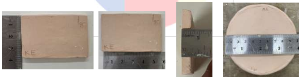
Gambar 4.71 Proses Uji Coba Dimensi (Biskuit)
