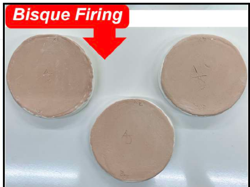
Gambar 4.57 Perbandingan Sampel Tiles dan Produk ( Bone Dry dan Bisque )
