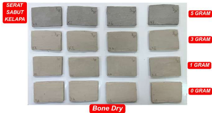
Gambar 4.35 Hasil Sampel Basah dan Hasil Sampel Kering ( Bone Dry )
