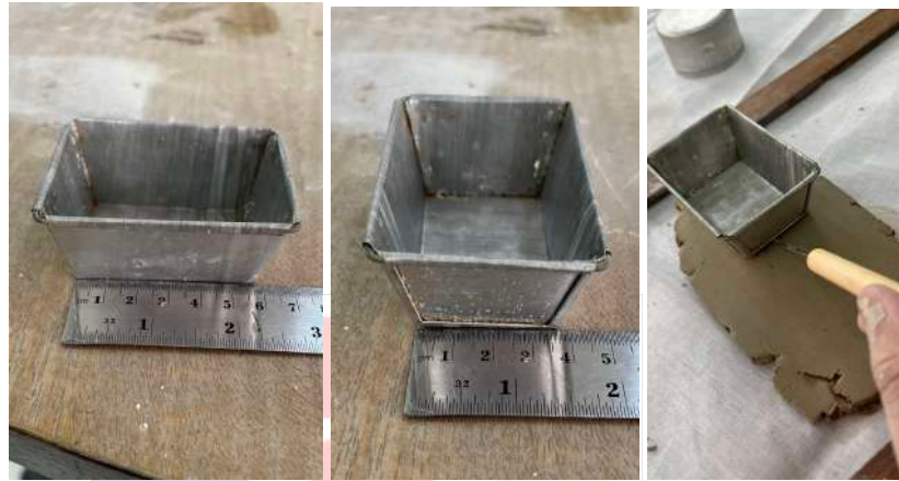
Gambar 4.34 Uk. Panjang 5,5 cm, Uk. Lebar 3,5 cm dan Proses Cetak Sampel sumber: Dokumentasi Pribadi (2025)
