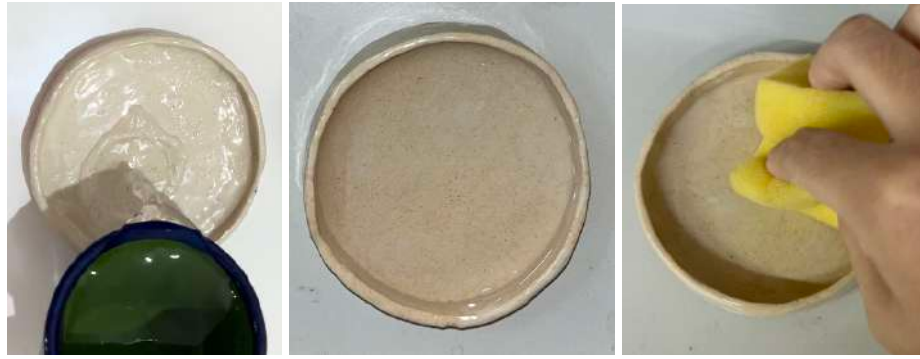
Gambar 4.79 Proses Uji Coba Daya Serap Air (Sample Produk)
