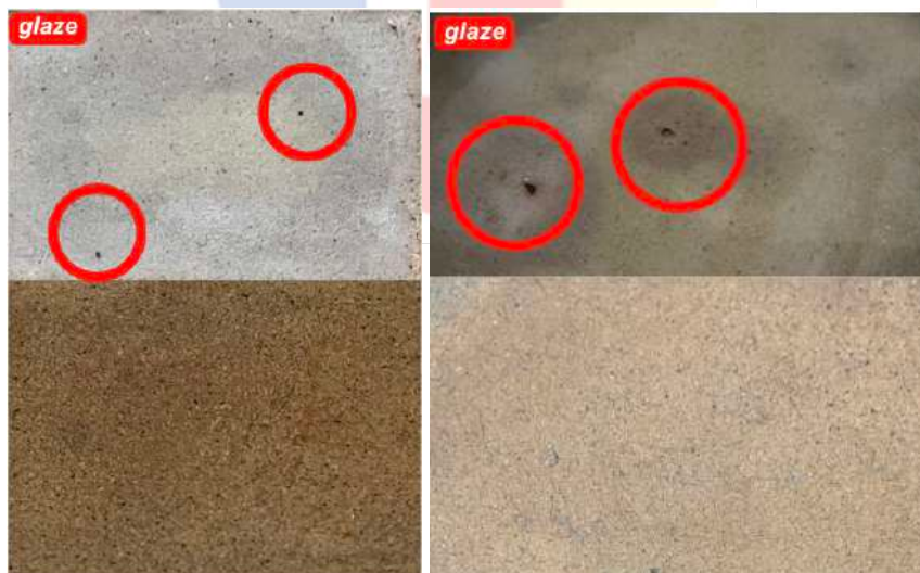
Gambar 4.65 Detail Sampel Tiles dan Produk Abu Sabut Kelapa (1 gram)
