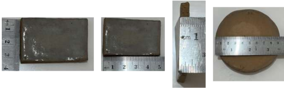
Gambar 4.72 Proses Uji Coba Dimensi (Glasir)
