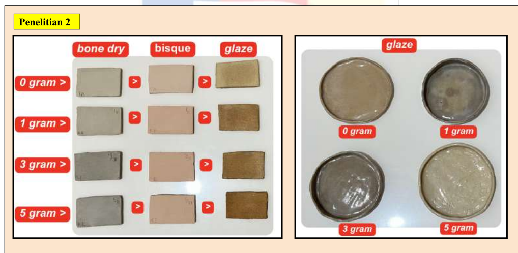
Gambar 4.62 Perbandingan Pembakaran Penelitian 1 dengan Penelitian 2 sumber : Dokumentasi Pribadi (2025)
