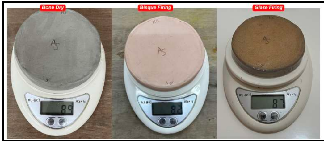
Gambar 4.74 Proses Uji Coba Berat (Sample Produk)
