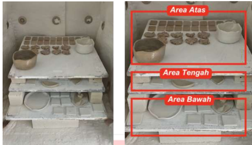
Gambar 4.61 Loading Out dan Area Letak Bakar Glasir
