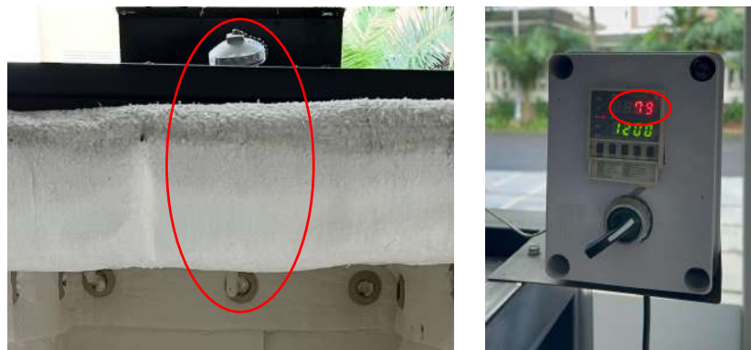
Gambar 5.43 Termokopel Tungku Gas dan Suhu Awal Tungku
