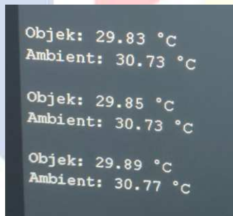
Gambar 4.23 Hasil Eksperimen Suhu Lingkungan Sekitar Tanpa Memasak
