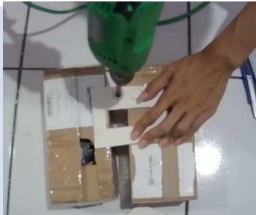
Gambar 5.29 Proses Pembuatan Lubang Casing (Sumber : Dokumentasi Pribadi)
