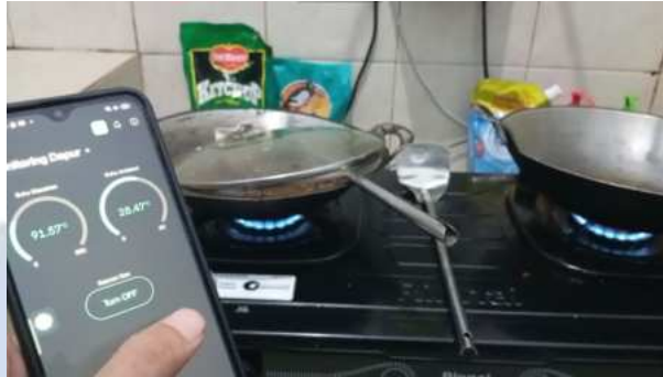
Gambar 5.55 Uji Coba Mematikan Kompor Melalui Ponsel Sebelum Tombol “Turn OFF” Ditekan (Sumber : Dokumentasi Pribadi)
