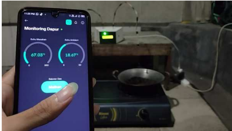
Gambar 5.37 Setelah Tombol Mematikan Kompor Ditekan (Sumber : Dokumentasi Pribadi)
