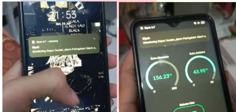
Gambar 5.42 Uji Coba Prototipe Setelah Ditinggalkan Saat Menggoreng
