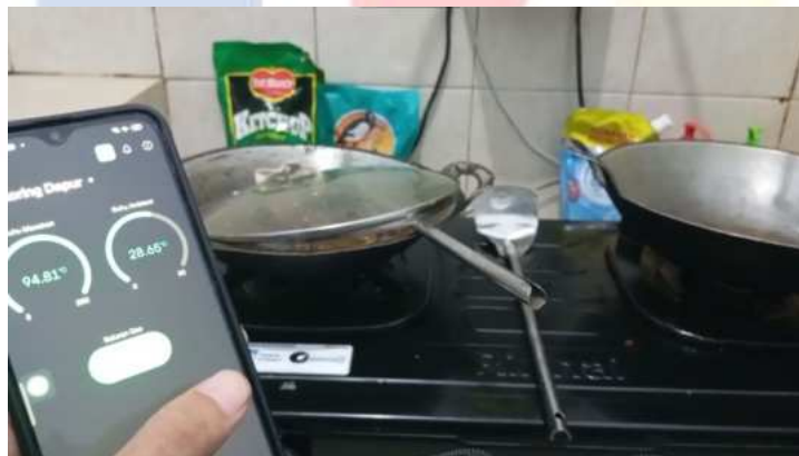
Gambar 5.56 Uji Coba Mematikan Kompor Melalui Ponsel Sesudah Tombol “Turn OFF” Ditekan (Sumber : Dokumentasi Pribadi)
