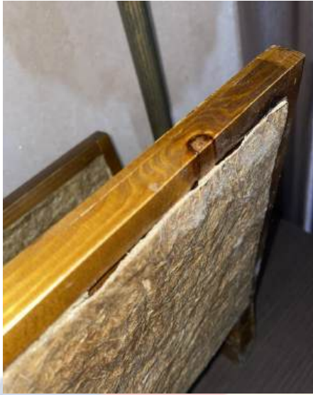
Gambar 5. 43 Kulit Jagung bergelombang hingga tidak bisa di rekatkan dengan baik
