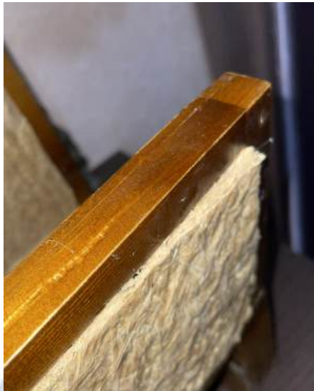
Gambar 5. 45 Ketebalan Kulit jagung yang tidak rata
