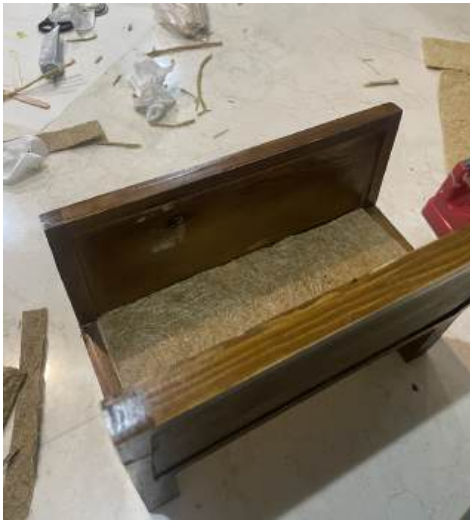
Gambar 5. 39 Pemasangan Kulit jagung kepada alas
