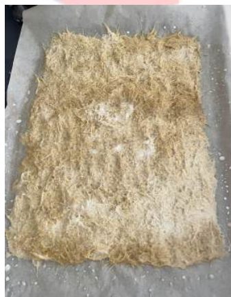
Gambar 5. 41 lem PVA tidak tersebar dengan rata saat pencampuran
