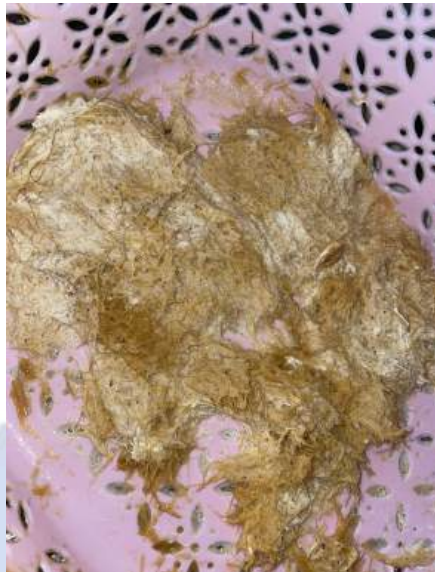
Gambar 5. 12 Kulit Jagung yang di campur lem PVA
