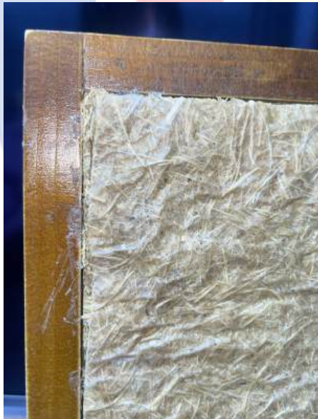
Gambar 5. 44 Kulit Jagung tidak terpotong dengan rata
