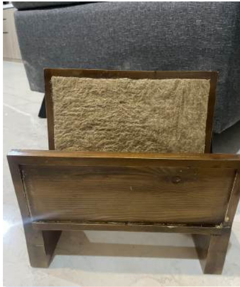
Gambar 5. 35 Pemasangan Kulit Jagung ke rangka sandaran belakang (Sumber: Dokumentasi Pribadi,2025)
