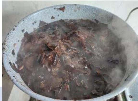
Gambar 8 Pemasakan Daun Jati Kering dengan larutan NaOH. Sumber: Imas Arista, 2022
