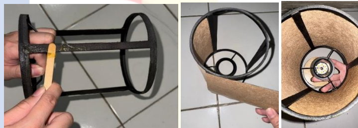
Gambar 109 Pengelemat kertas daun Jati dan menyatukan diffuser dengan dudukan lampu Sumber: Pribadi
