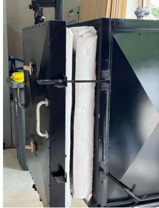
Gambar 4.3 pintu tungku yang sedikit terbuka
