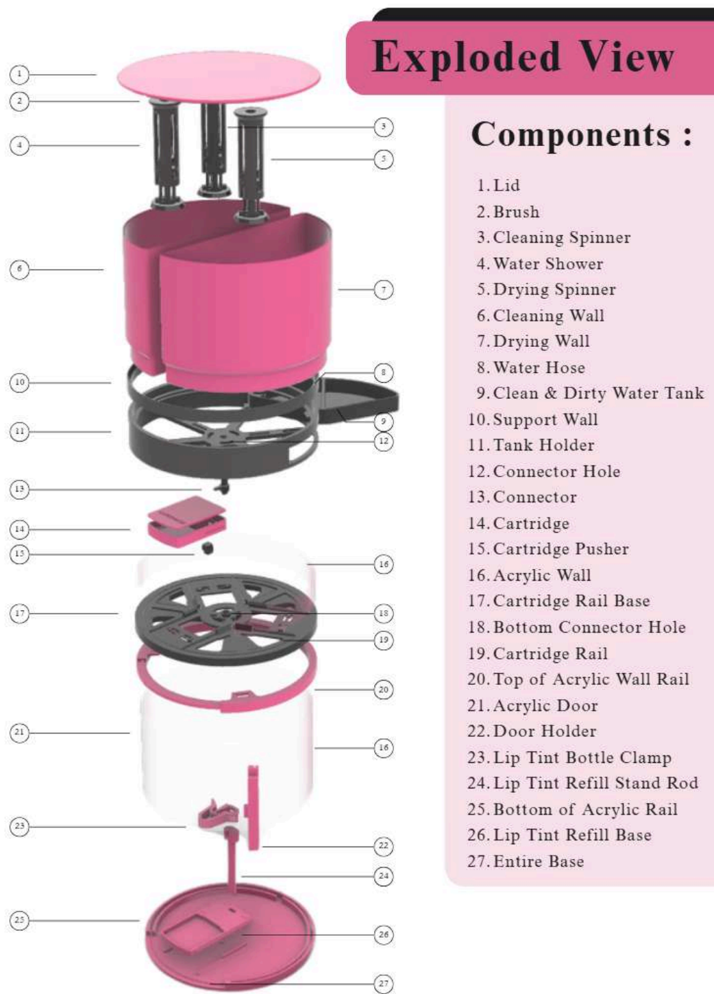
Gambar 5.17 Exploded View (Sumber: Dokumentasi Pribadi, 2025)
