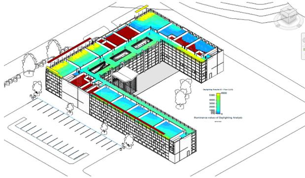
Gambar 2. 16. Analisa pencahayaan menggunakan Autodesk Revit.
