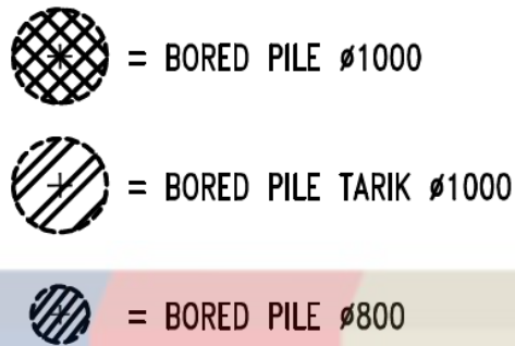
Gambar IV.1 Jenis Pondasi Bored Pile (Sumber: Dokumen Proyek, 2019)
