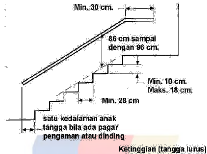
Gambar 2. 10 Standar Optrede dan antrede anak tangga
