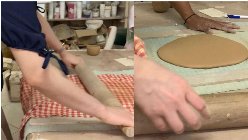
Gambar 4.32 Proses Pengilingan Tanah liat (Sumber : Dokumentasi Pribadi)
