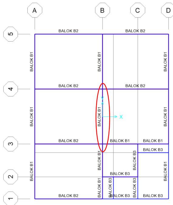
Gambar 4.12 Bagian Balok yang akan Ditinjau
