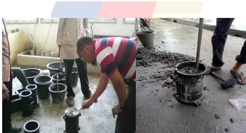
Gambar III.2 Proses Penuangan Beton Segar dan Pemadatan dengan Metode Penusukan
