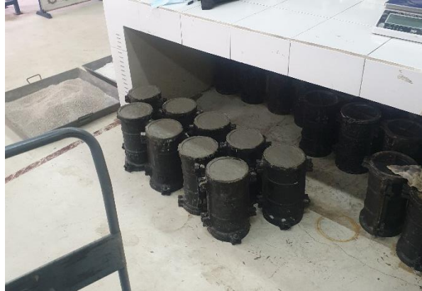
Gambar IV.15 Pengeringan beton benda uji setelah pencetakan (Sumber: Olahan Pribadi)
