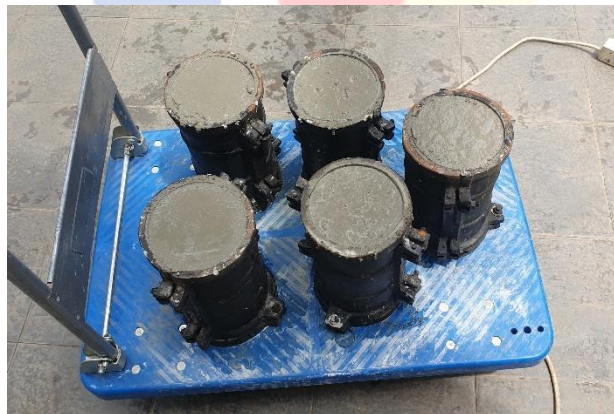
Gambar IV.14 Hasil Pencetakan Beton Segar ke dalam Cetakan (Sumber: Olahan Pribadi)
