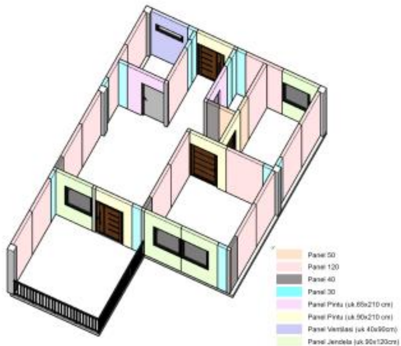
Gambar 5. 30. Aksonometri Prefabrikasi Unit 2
