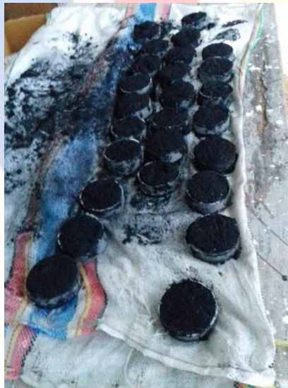
Gambar 4.9 Proses pencetakan briket
