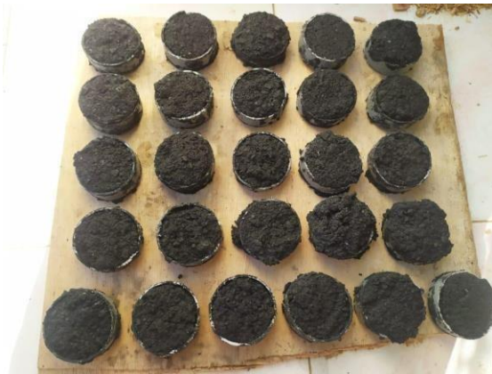
Gambar 4.10 Proses pengeringan briket.
