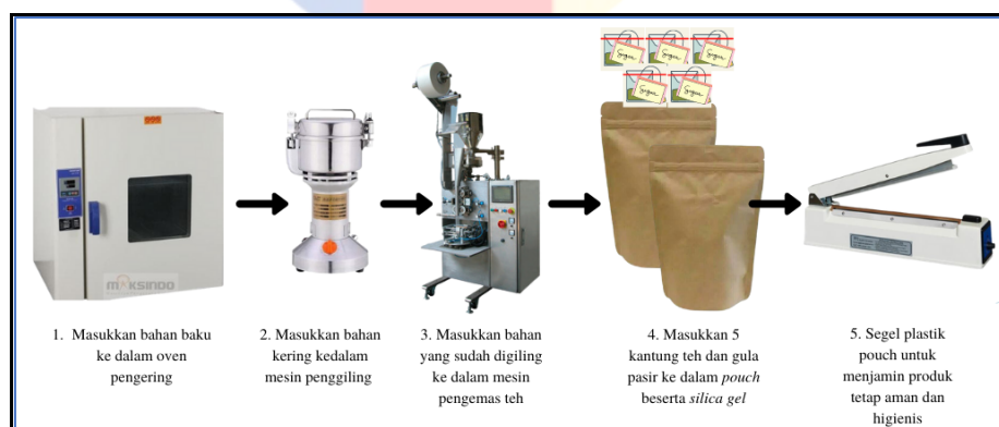
Gambar 4. 14 Proses Produksi Ramuin Kering
