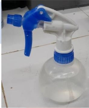
**Gambar 4.16 Spray Air untuk Uji Gesek Basah**
