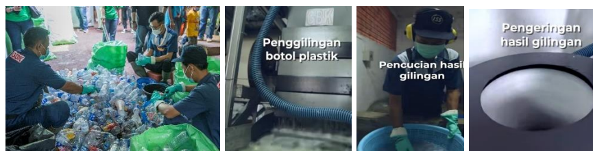
Gambar 2.13 Proses Pencucian Sampah Plastik di GBK (Sumber: Gelora Bung Karno)
