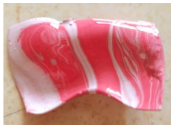
Gambar 2.21 Teknik Hydrodipping pada Plastik (Sumber: Dokumentasi Pribadi, 2022)
