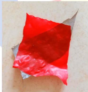
Gambar 2.19 Teknik Fusing Sampah Plastik (Sumber: Dokumentasi Pribadi, 2022)
