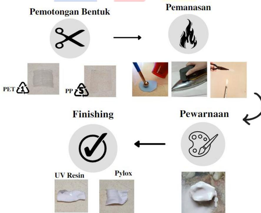
Gambar 3.6 Alur Proses Pewarnaan/*Finishing* dengan Teknik *Spray* Menggunakan Cat *Pylox*
