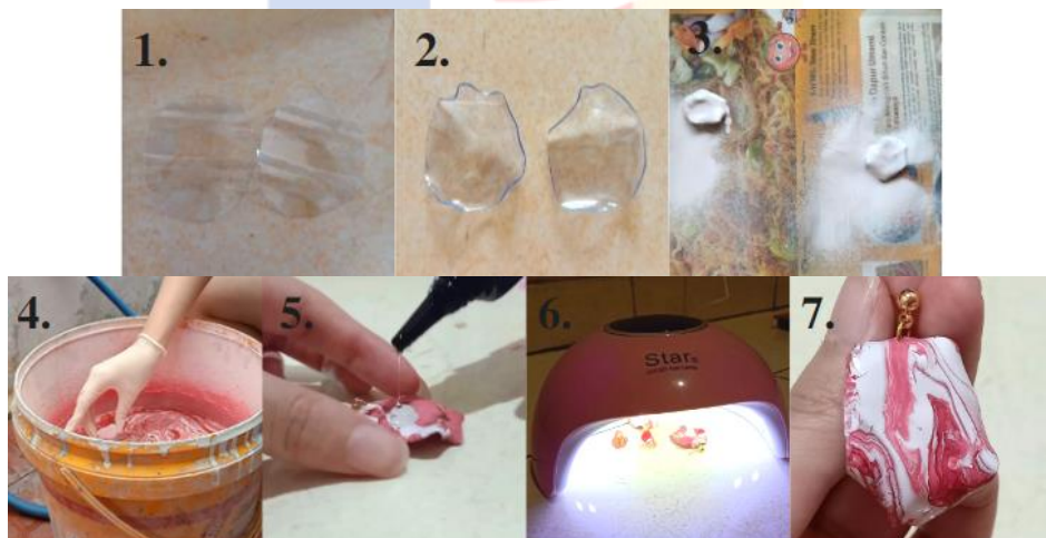
Gambar 4.13 Alur Proses Pembuatan Anting PET dengan Pewarnaan Hydrodipping (Sumber: Dokumen Pribadi, 2022)
