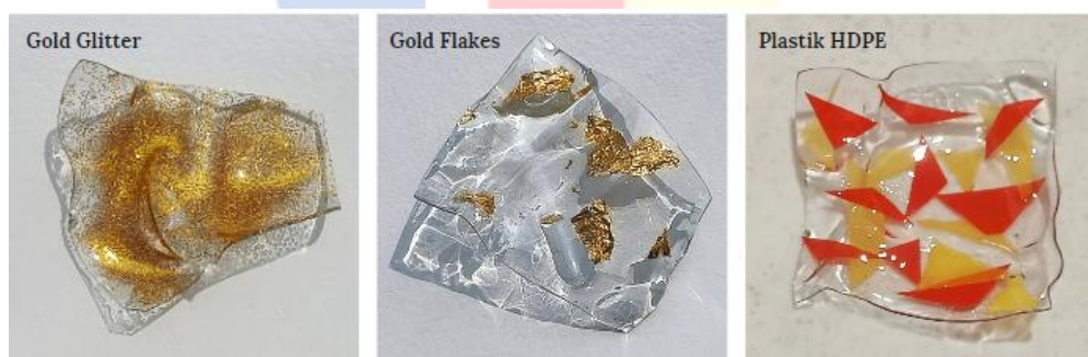
Gambar 4.11 Hasil Penambahn Dekorasi dengan Finishing UV Resin (Sumber: Dokumen Pribadi, 2022)
