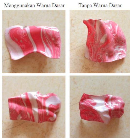
Gambar 4.9 Perbedaan Pewarnaan dengan Teknik Hydrodipping Menggunakan Warna Dasar dan Tidak (Sumber: Dokumen Pribadi, 2022)
