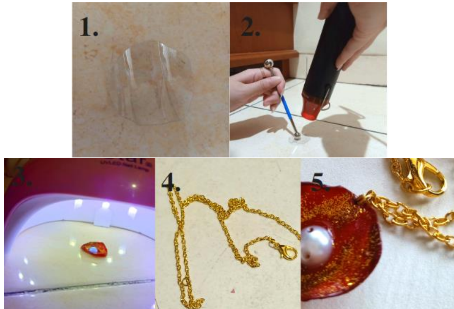
Gambar 4.19 Alur Proses Pembuatan Kalung PET dengan Pewarnaan Pylox (Sumber: Dokumen Pribadi, 2022)
