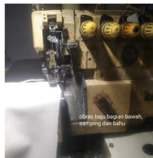
7. Mengobras bagian bawah, samping, dan bahu baju dengan mesin jahit
