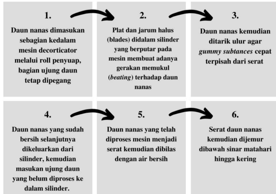
Gambar 2.18 Tahapan Pengolahan Serat Daun Nanas dengan Mesin Sumber: Dokumen Pribadi
