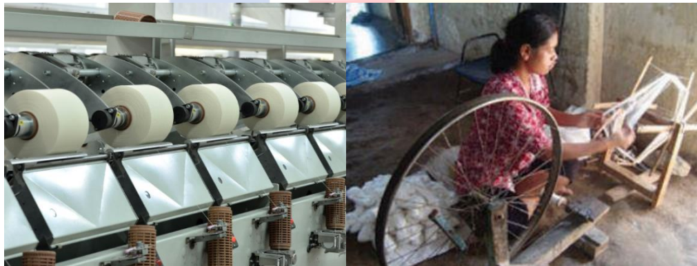
Gambar 2. 21 Mesin pinal modern dan tradisional Sumber: (a) Lancangkuning, (b) Kelas Online
