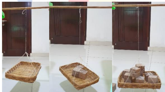
Gambar 4. 33 Eksperimen Uji Kekuatan Benang Nanas Sumber: Dokumen Pribadi
