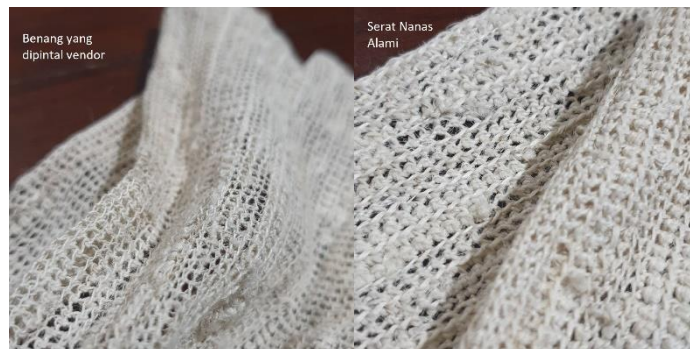
Gambar 4. 45 Detail Sampel Rajut Benang Dipintal Vendor dan Serat Alami Sumber: Dokumen Pribadi
