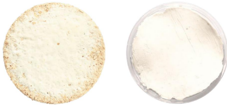
Gambar 6 – Komposit Miselium (kiri) dan Miselium Murni (kanan) (Karana, 2018)
