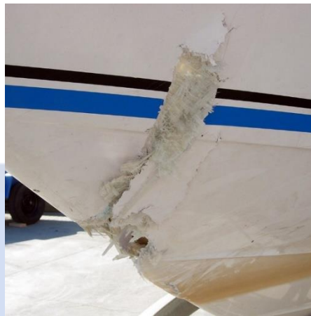
Gambar 2. 15 Bagian Kapal Yang Pecah Dengan Material Fiberglass (yellowcu151.weebly.com)
