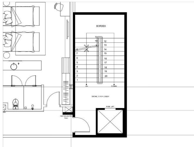
**Gambar 4.2.1.4 Gambar 2D Denah Detail Timur Tangga Kebakaran**
