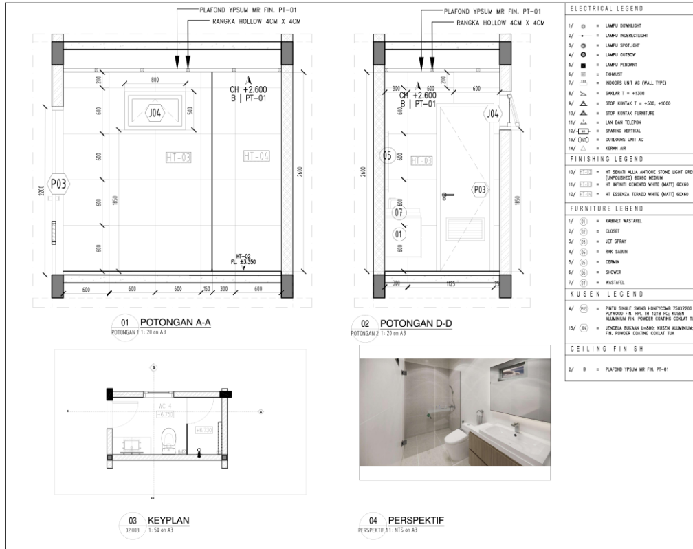
Gambar 4.2.3.2. Gambar Kerja Detail Potongan Ruang WC
