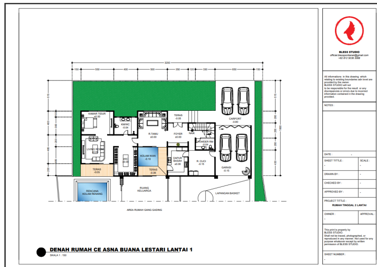
Gambar 4.2.1.1 Denah Lantai 1 Sumber: Pribadi
