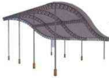
ATAP BENTANG LEBAR - STRUKTUR TRUSS
