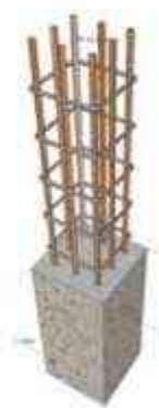
KOLOM BETON BERTULANG DIAMETER 600 MM
