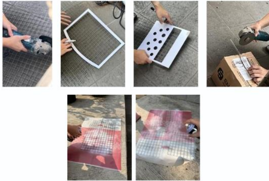
Gambar 4. 75 Pemotongan kawat ayam dan tube akrilik
