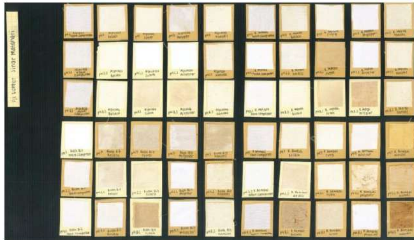
Gambar 4.42: Hasil Uji Luntur Dijemur di Bawah Sinar Matahari
