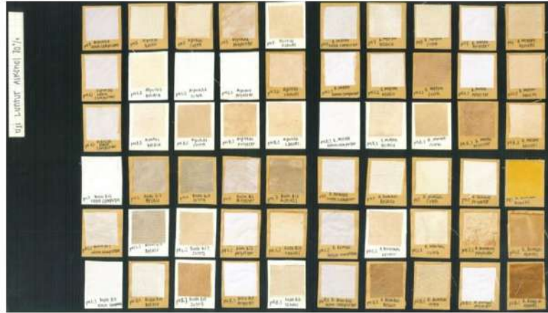
Gambar 4.38: Hasil Uji Luntur Menggunakan Alkohol 70%
