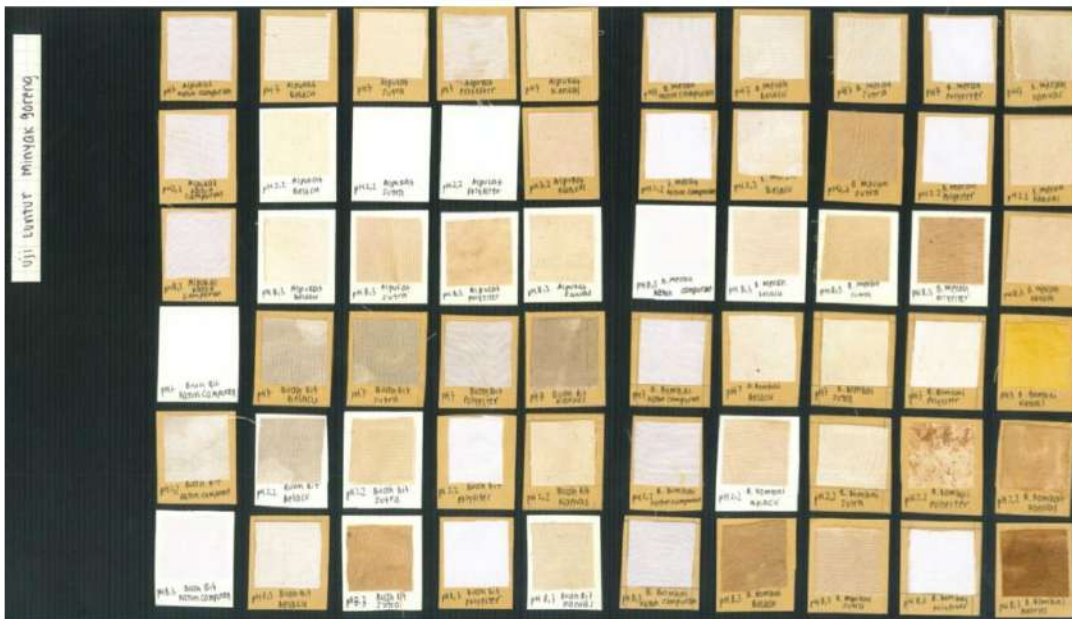
Gambar 4.36: Hasil Uji Luntur Menggunakan Minyak Goreng
