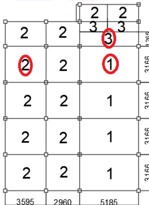
Gambar IV.1 Pembagian Tipe Pelat Desain Bangunan A
